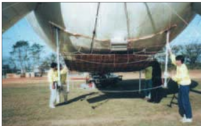
Рис.2. Нижняя часть дирижабля с установленной ректенной
