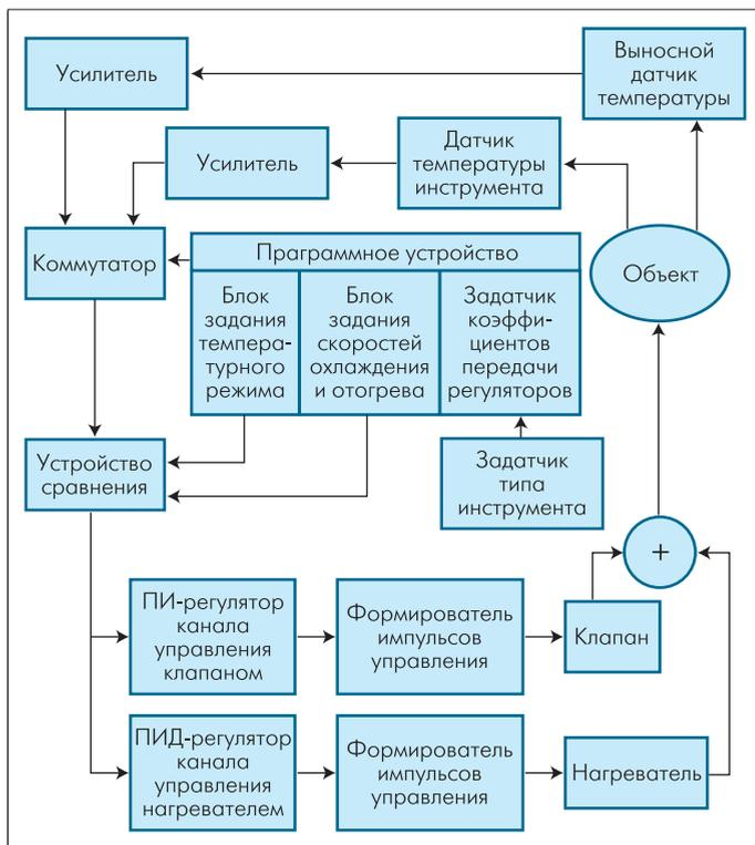
Рис.3. Структурная схема каналов управления криоаппарата
