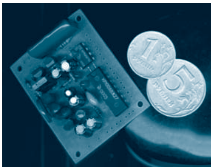
Рис. 9. Телефонный модуль на основе комплекта ИС ОАО "Ангстрем" (КР1008ВЖ27 и КР5001ГП1)
