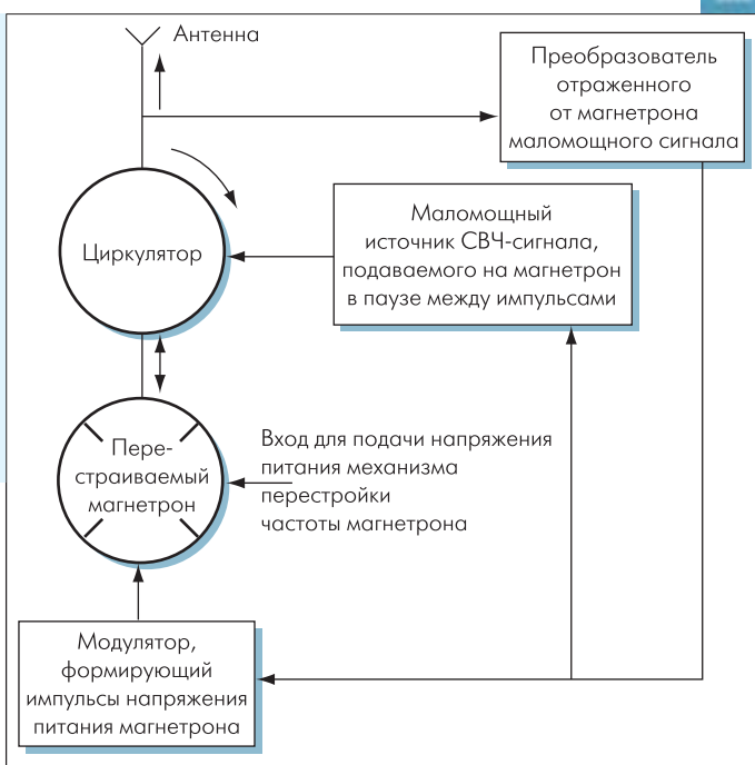
Рис. 1. Система управления частотой быстроперестраиваемого магнетрона
