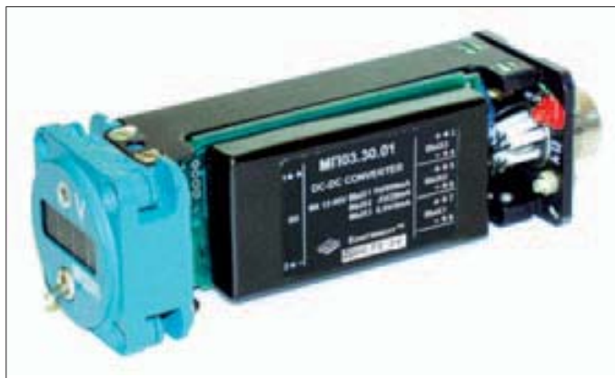
Рис. 6. Цифровой вольтметр с DC/DC-преобразователем торговой марки КОНТИНЕНТ
