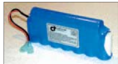
Рис. 8. Аккумуляторные сборки в термоусадочной пленке
