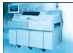
**Рис.6. Зондовая система производственного контроля Pilot LX фирмы GenRad**
