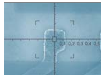
Рис. 4. Фотография печатной платы при 100-кратном увеличении. Прямоугольник в центре указывает место и размеры измеряемого участка
