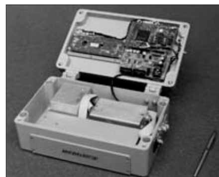
Рис. 4. Опытный образец бескарданного магнитного индукционного компаса
