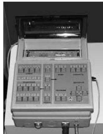
Рис.4. Пульт управления пожарного модуля
