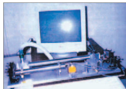
Рис. 3. Лазерно-спектроскопический детектор летучих компонентов взрывчатых веществ
