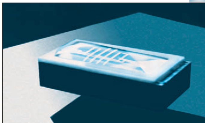
Рис. 5. Внешний вид СВЧ-устройства контроля микроорганизмов, разработанного на фирме "Гамма"
