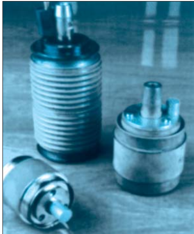
В числе перспективной продукции "Тория" – вакуумные дугогасительные камеры для высоковольтных выключателей, которые эффективно используются в энергетических системах, городских коммутационных сетях, на транспорте.
