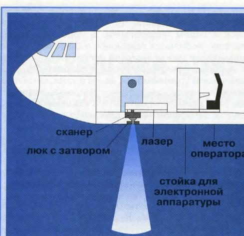
Рис. 2. Бортовая лидарная установка для измерения ветрового профиля
