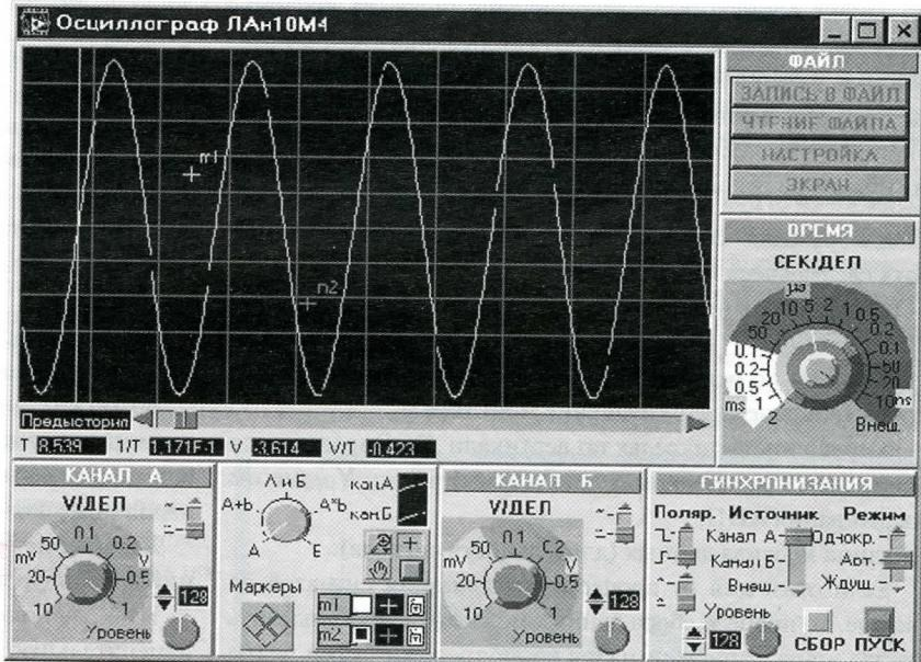
Рассмотрим подробнее виртуальный осциллограф, реализованный на плате сбора данных ЛА-10 ЗАО «Руднев-Шиляев». Программно-аппаратный комплекс ЦЗО-01 представляет собой виртуальный измерительный прибор Цифровой Запоминающий Осциллограф (ЦЗО), графическая панель которого показана на рисунке. ЦЗО-01 предназначен для наблюдения, измерения временных и амплитудных параметров, регистрации как случайных (однократных), так и периодических процессов.
