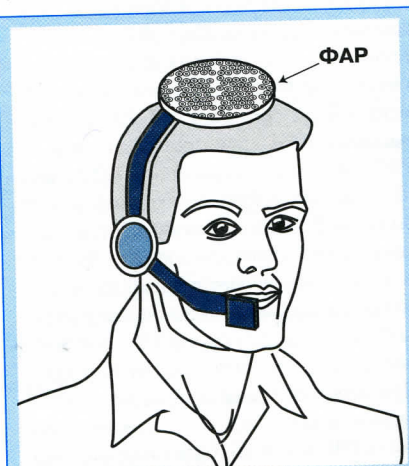
Рис. 2. ФАР системы персональной связи, размещенная на голове пользователя
