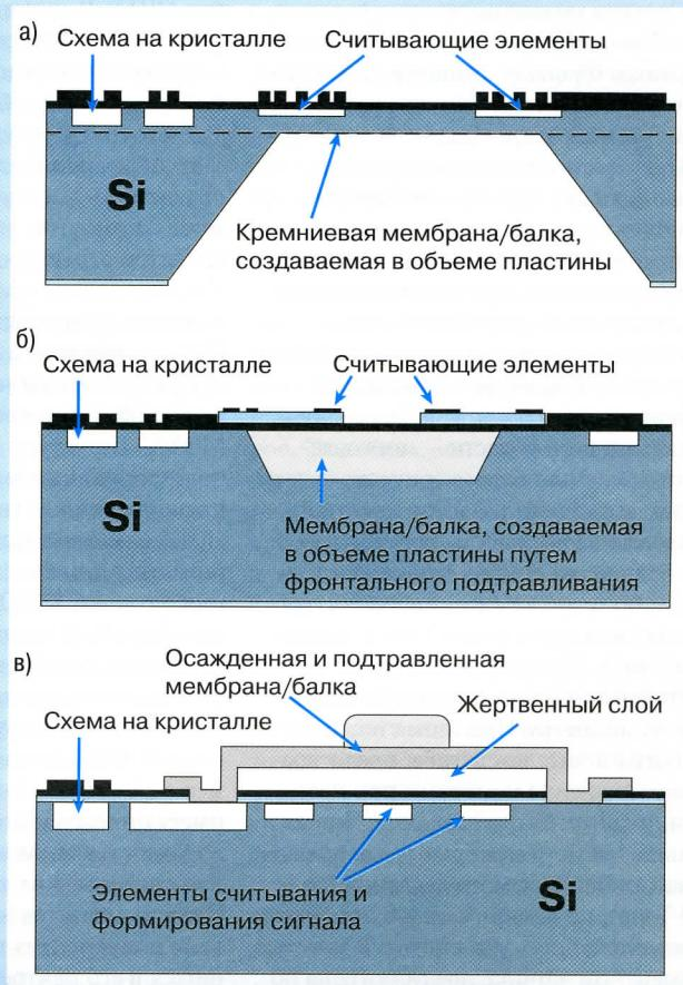
Рис. 2. Базовые приборные структуры микросистем:
