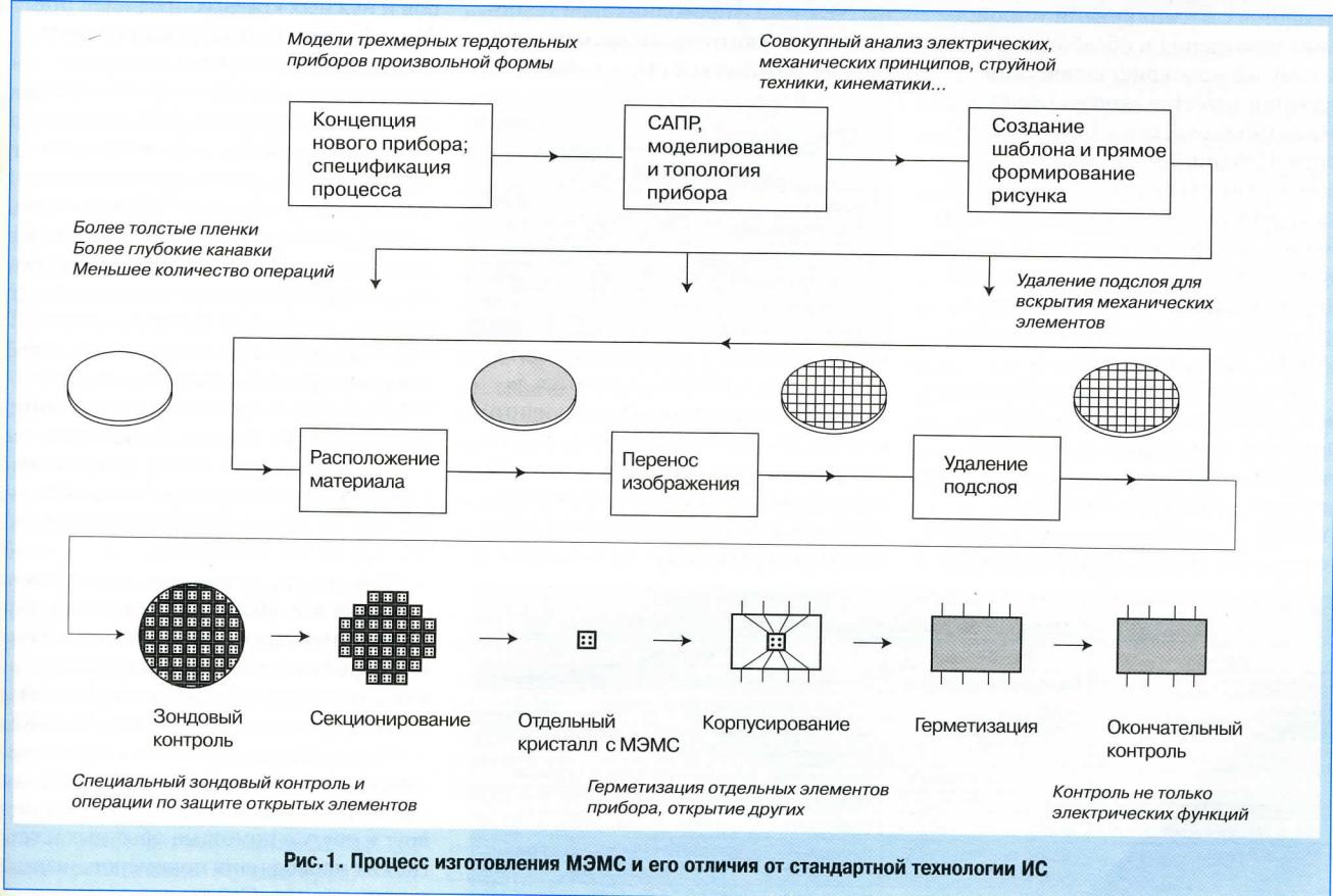
Рис. 1. Процесс изготовления МЭМС и его отличия от стандартной технологии ИС
