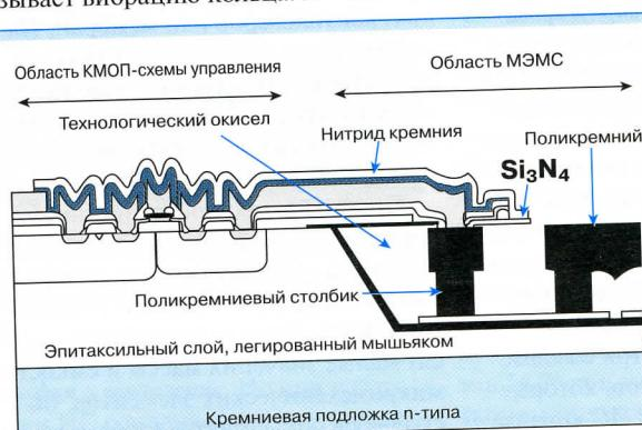
Рис.3. Структура МЭМС акселерометра Сандийской национальной лаборатории
