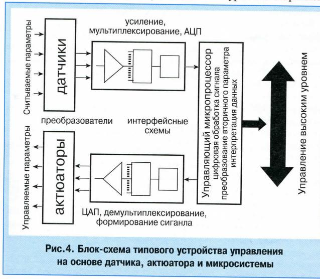
**Рис.4. Блок-схема типового устройства управления на основе датчика, актуатора и микросистемы**
