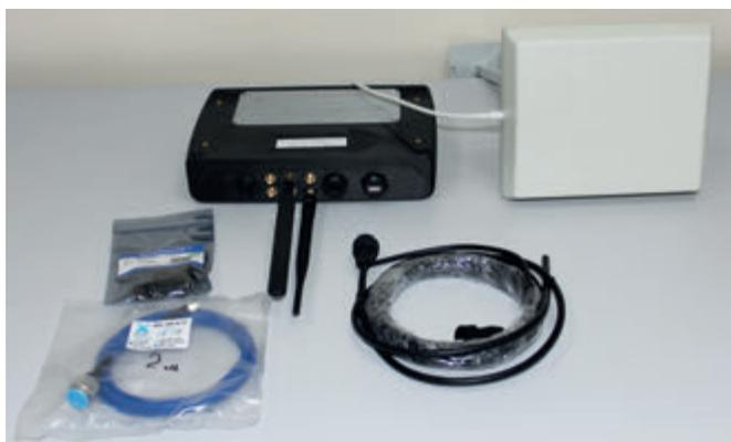
**Рис. 7.** Радионавигационный датчик для навигации внутри помещений
