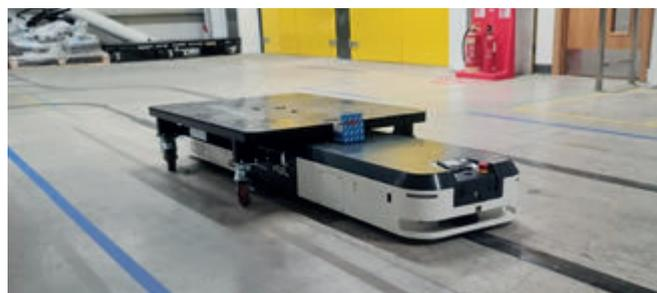
**Рис. 2.** Мобильный робот, использующий для навигации магнитную ленту
