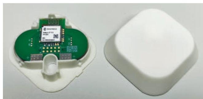
Рис. 6. Bluetooth-маяк на основе модуля ПР4502 для системы навигации внутри помещений
