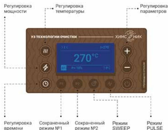
Рис. 1. Панель управления цифровых ванн «ХимСоник» (серии «Стандарт», «Профи», ВГ)
