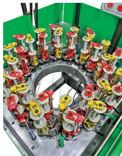
Рис. 14. Станок для оплетения жгутов на 36 катушек с нашей доработкой
