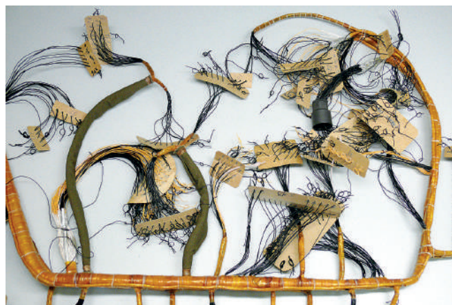
Рис. 4. Раскладка проводов в оснастку с имитацией разъема
