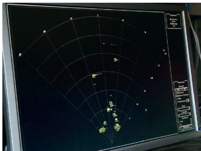
Рис. 2. Вид дисплея автомобильной СКИ РЛС
