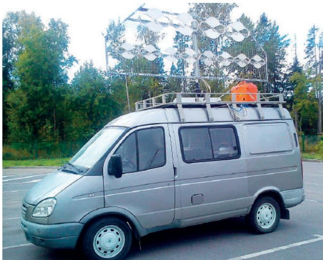
**Рис. 1.** Мобильная экспериментальная лаборатория SKI РЛС
