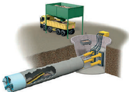
Рис. 4. Микро- тоннели- рование [5]
