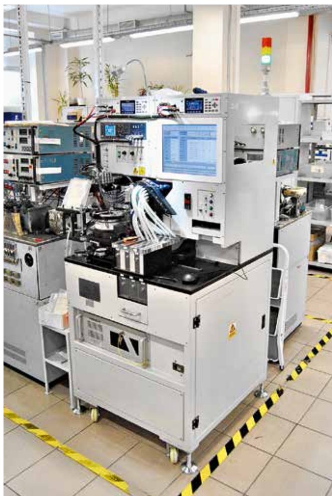
Новая установка контроля электрических параметров
