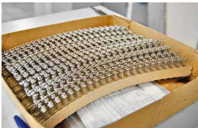
Конденсаторы с припаянными выводами в ленте-носителе
