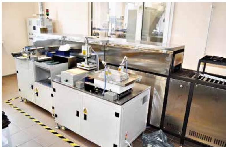
Оборудование, на котором выполняется серебрение контактов компонентов типоразмера 1005M
