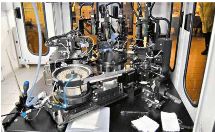
Внутреннее пространство автомата контроля внешнего вида
