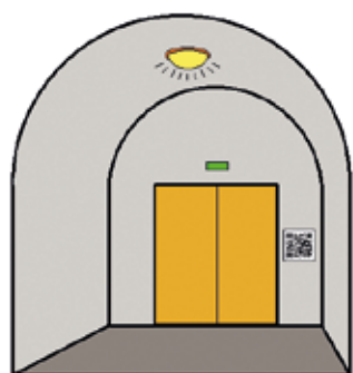
Рис. 2. Метка в виде QR-кода на границе переходной зоны
