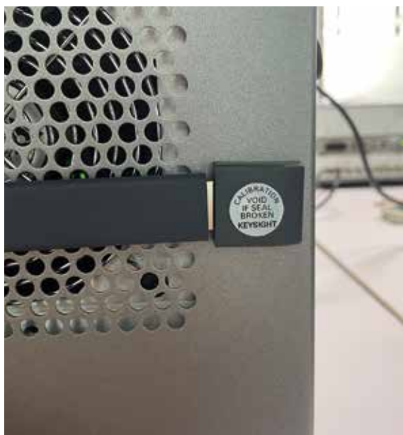
Рис. 3. Оригинальные информаци- онные бирки и защитные пломбы
