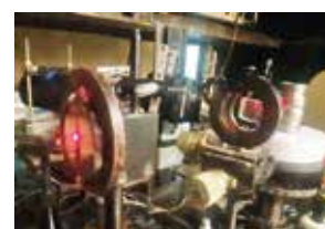
Рис. 2. Фото установки с включенным лазером. 1 – лазер ДМ-8-650, 2 – поляризатор, 3 – затемнитель, 4 – цилиндрическая линза, 5 – деталь, 6 – объектив ГЕЛИОС, 7 – PZS-линейка K1200ЦЛ-1
