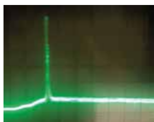
Рис. 3. Движение осциллограммы при микросмещении детали
