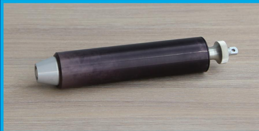
Предназначено для испытаний изделий на механическую прочность ударом (энергия удара до 1 Дж) в соответствии с требованиями ГОСТ IEC 60065-2013 п.12.1.3; ГОСТ 27570.0-87 (МЭК 335-1-76) п.22.1; ГОСТ 30324.0-95 п.21
