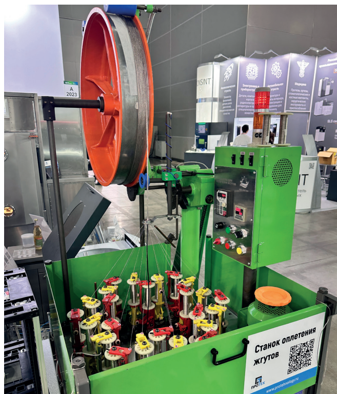
Рис. 8. Станок для оплетения жгутов на 24 катушки на выставке ExpoElectronica
