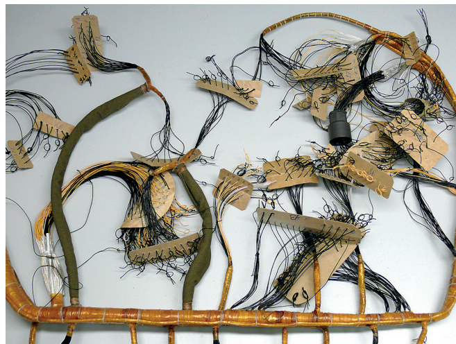
Рис. 2. Раскладка проводов в оснастку с имитацией разъема
