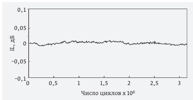
Рис. 38. Зависимость вносимых потерь в изделиях MM5120 и MM5130 от количества циклов переключения (при температуре окружающей среды 20 °С и мощности входного сигнала 10 дБм)
