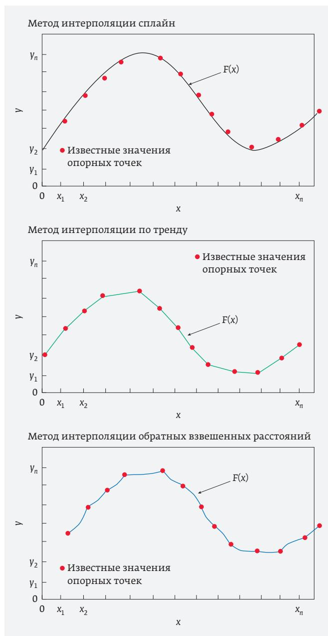
Рис. 1. Графики для детерминированных методов интерполяции
