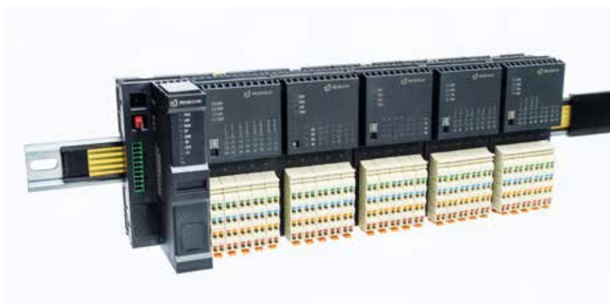
ПЛК с модулями ввода и вывода разработки ООО «Континент ЭТС»
