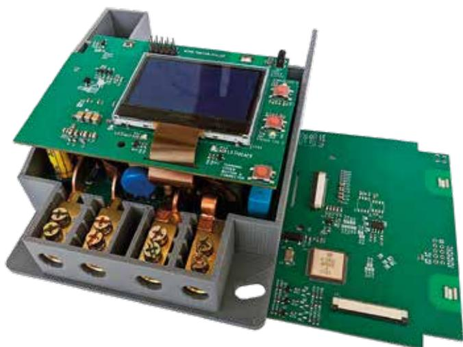
Кроме того, так как в проекте используется внешняя микросхема метрологического фронтенда, данный микроконтроллер может применяться и в трехфазном приборе учета без значительных изменений.
