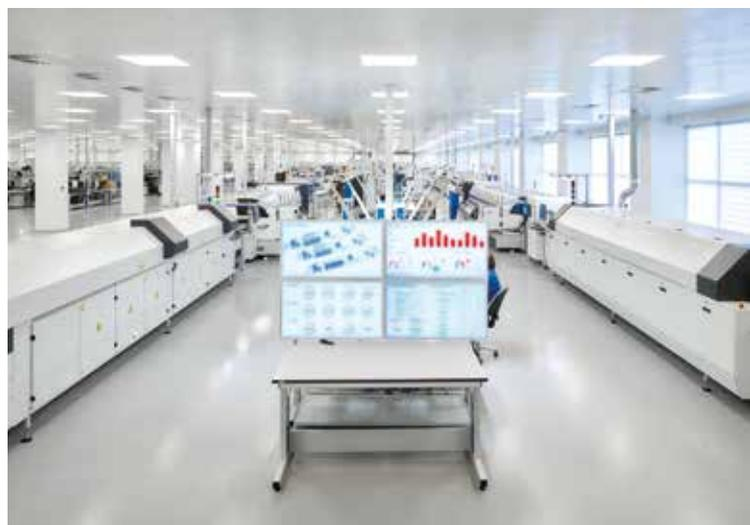
Рис. 2. Линия поверхностного монтажа
