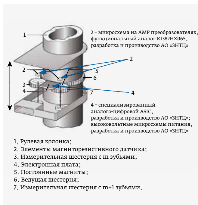
Рис. 8. Датчик угла поворота рулевого колеса
