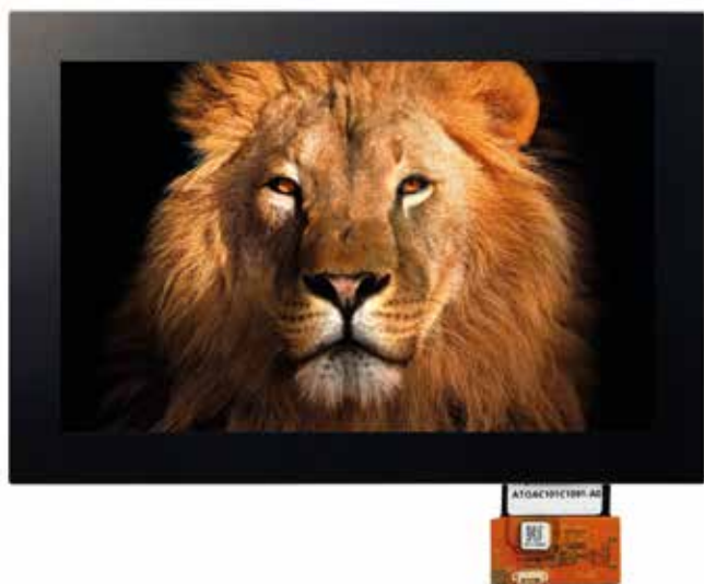
Рис. 4. Дисплейный модуль PH192108T005-ZHC01 с использованием рамки, создающей эффект «черной панели»
