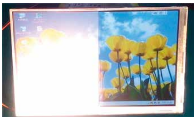
Рис. 1. Широкоформатный дисплей PH280142T001-ZBR (технологии COG и COF)
