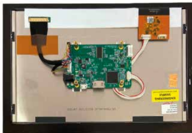
Рис. 6. Дисплейный модуль PH128800T007-ZHC04 с платой видеоконтроллера HDMI
