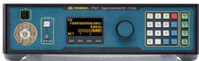
Рис. 2. Генератор сигналов Г4-РТА12 (проходит испытания в целях утверждения типа средств измерений)
