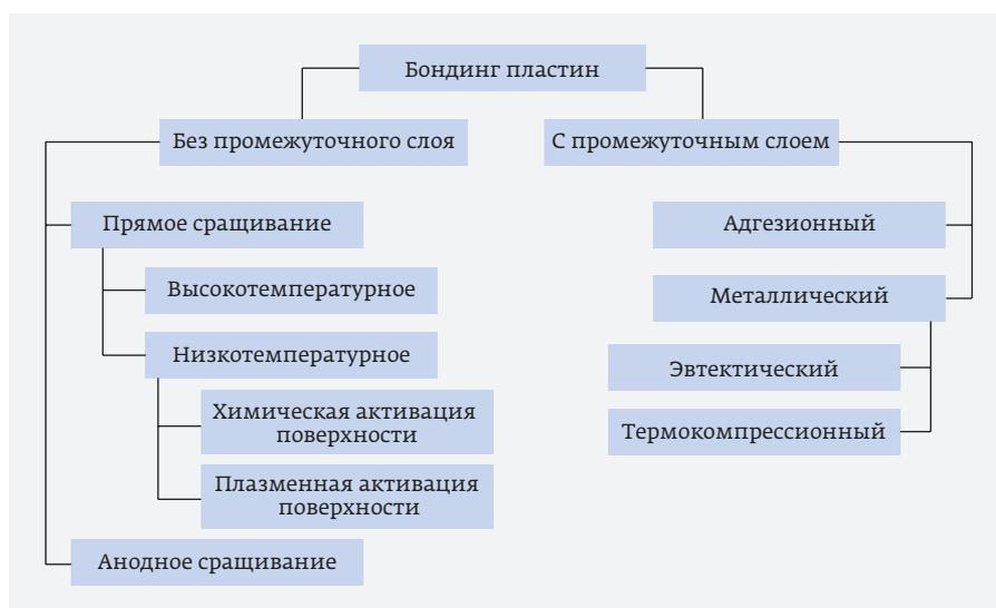
Рис. 1. Классификация технологий бондинга пластин в микроэлектронике
