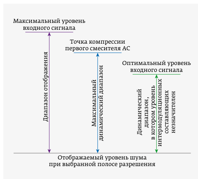
Рис. 1. Качественное соотношение диапазона отображения, максимального динамического диапазона и динамического диапазона, в котором уровень гармоник и продуктов интермодуляции незначителен
