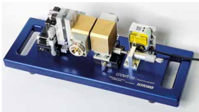
Рис. 1. Щелевой резонатор для измерения СВЧ-характеристик материалов
