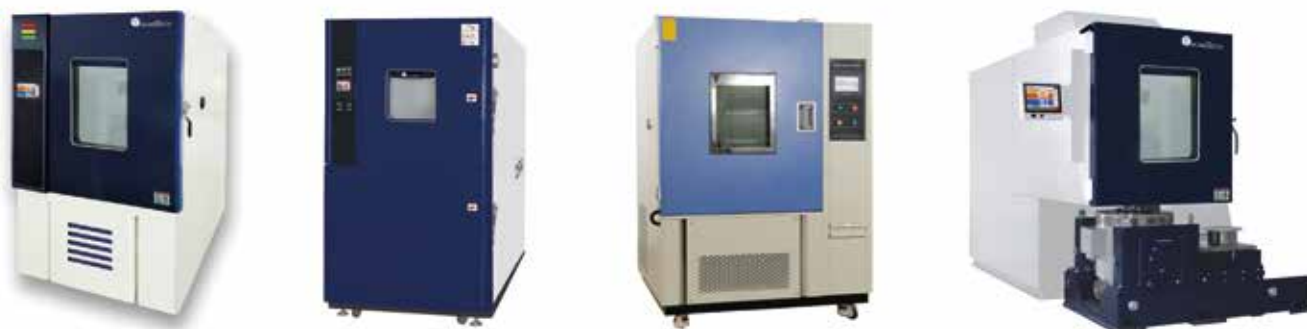
Рис. 1. Испытательные камеры с имитацией различных условий окружающей среды
