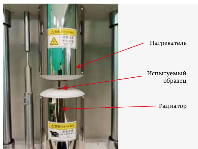
Рис. 3. Измеритель теплопроводности методом теплового потока по стандарту ASTM D 5470-06
