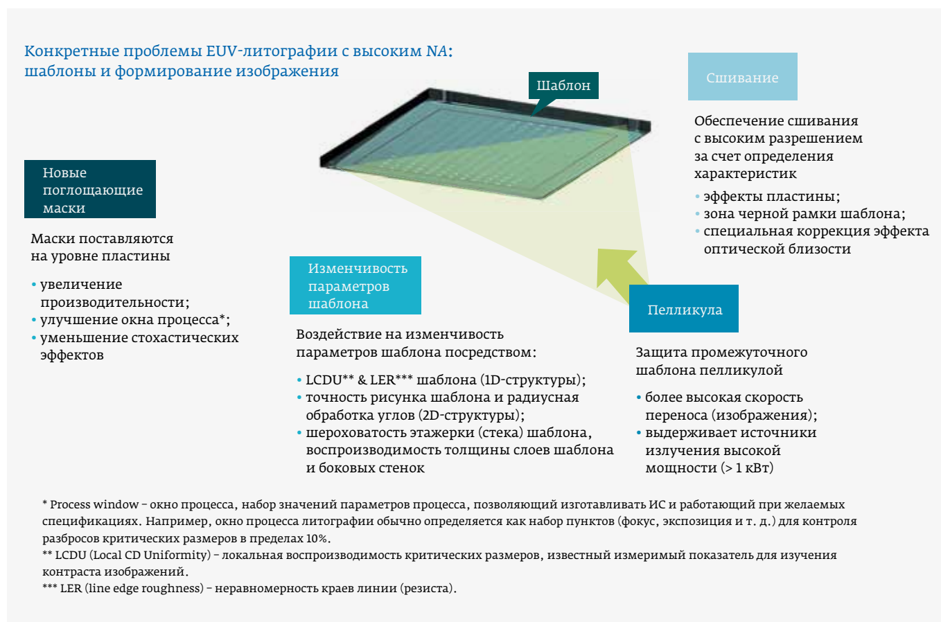
Рис. 2. Новый поглотитель с низкой диэлектрической проницаемостью в EUV-шаблоне улучшает окно процесса и снижает необходимую дозу экспонирования. Требуются дальнейшие улучшения в масштабировании сшивания, снижении разброса параметров шаблонов и разработке пелликул на углеродных нанотрубках (УНТ).
