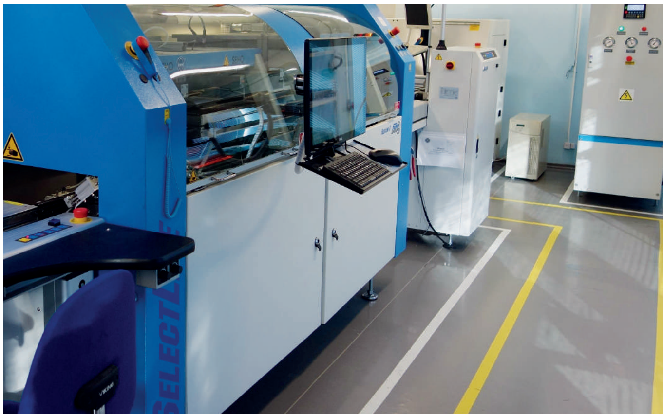
Рис. 2. Установка селективной пайки SelectLine-C
