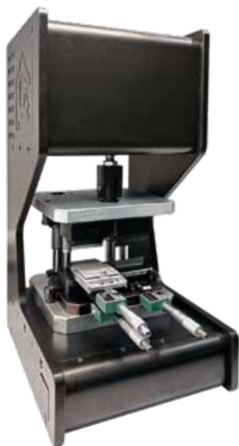
Рис. 4. Универсальный пресс для формовки и обрезки выводов ПРУФ-4 производства АО «Обуховский завод»
