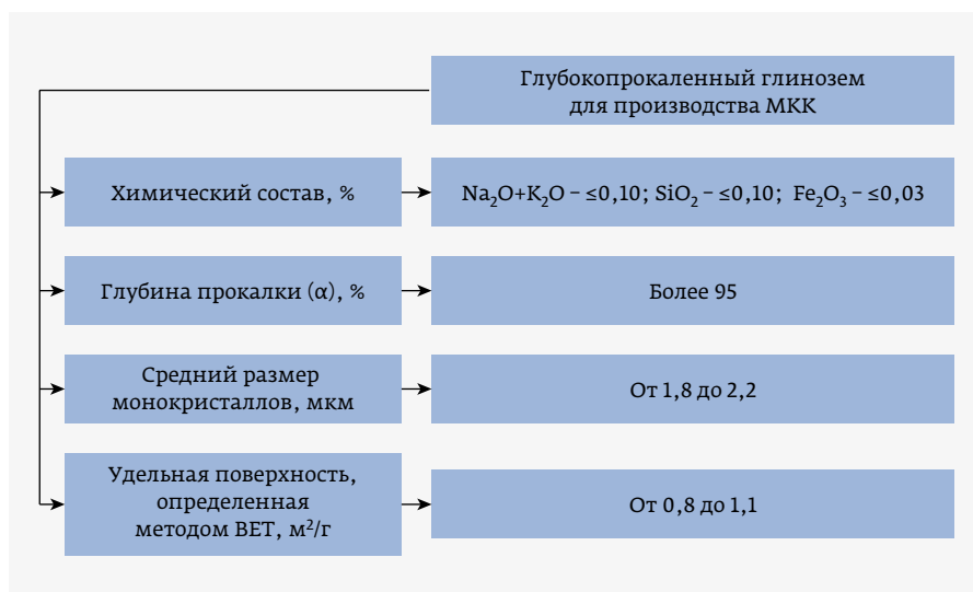
Рис. 1. Характеристики импортного глинозема
