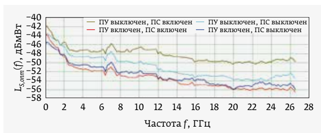
Рис. 10. Зависимости L_{s,omn}(f) для разных конфигураций линейного тракта АС
