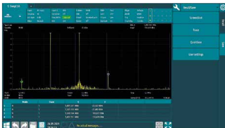
Рис. 7. Спектрограмма, полученная при измерениях IP3_{in} на частоте 5,5 МГц
