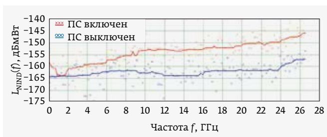
Рис. 3. Зависимости L_{NIND}(f) при выключенном предусилителе
