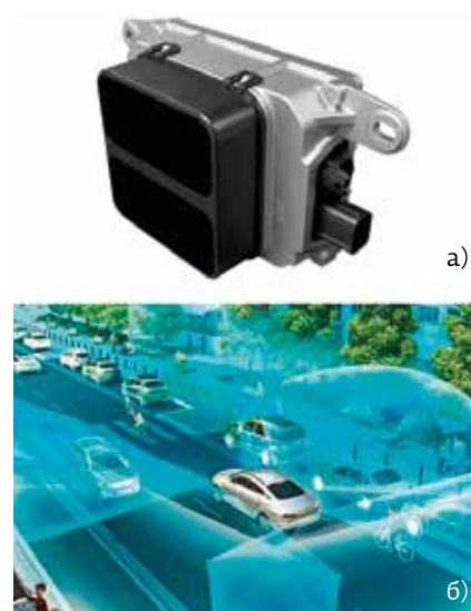
Рис. 1. Автолидар HFL110 (Continental AG, ФРГ): а – внешний вид лидара; б – работа лидара, установленного на движущемся автомобиле
