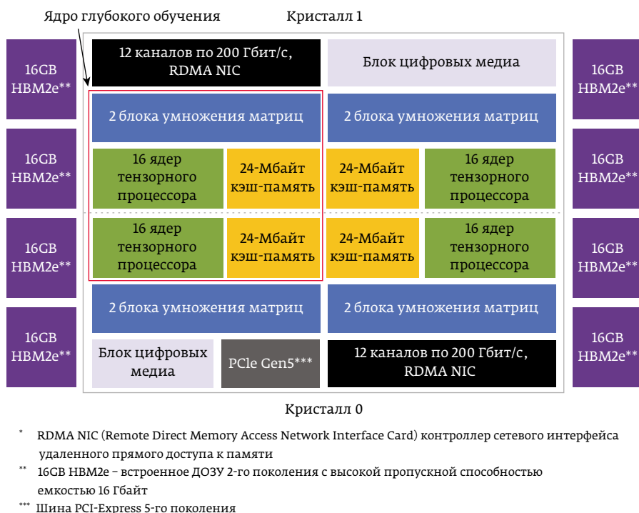
Рис. 2. Блок-диаграмма ИС ускорителя для обучения модели ИИ Gaudi 3 корпорации Intel. Источник: корпорация Intel (конференция Hot Chips 2024)
