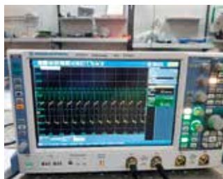
Рис. 7. Результаты испытаний с использованием дальномера лазерного типа: а – измерение дефекта формы детали из дюралюминия на анализаторе спектра за несколько секунд; б – показания анализатора спектра до и после микросмещения детали; в – фото экспериментальной установки: 1 – деталь на столе, 2 – дальномер
