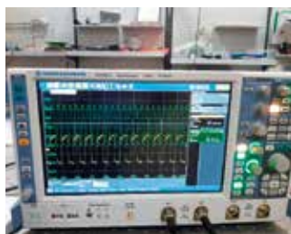
Рис. 7. Результаты испытаний с использованием дальномера лазерного типа: а – измерение дефекта формы детали из дюралюминия на анализаторе спектра за несколько секунд; б – показания анализатора спектра до и после микросмещения детали; в – фото экспериментальной установки: 1 – деталь на столе, 2 – дальномер
