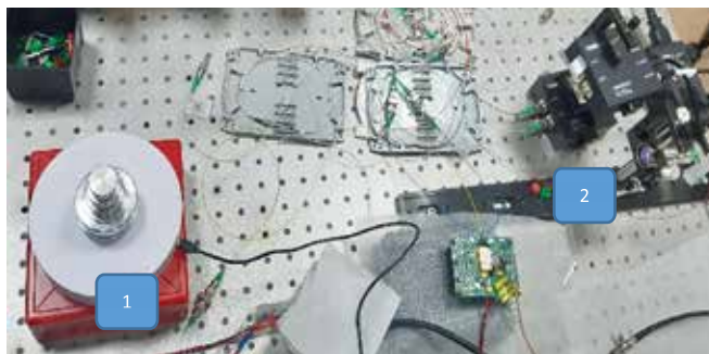
Рис. 7. Результаты испытаний с использованием дальномера лазерного типа: а – измерение дефекта формы детали из дюралюминия на анализаторе спектра за несколько секунд; б – показания анализатора спектра до и после микросмещения детали; в – фото экспериментальной установки: 1 – деталь на столе, 2 – дальномер
