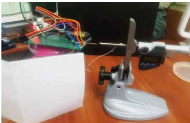
Рис. 12. Калибровка емкостного щупа с помощью цифрового глубиномера
