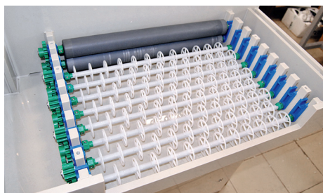
Механизм приводного конвейера на полипропиленовой опоре
