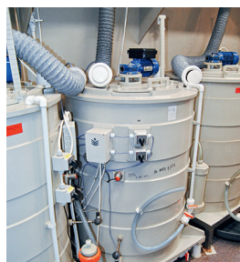
Один из реакторов. Сверху видны планка для измерения уровня жидкости и местная вытяжка
