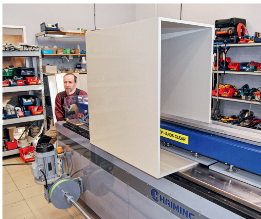
Стыковая сварка корпуса ванны
