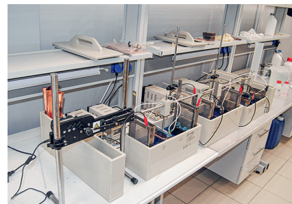
Отработка процесса гальванического меднения с новой добавкой, который готовится к выводу на рынок
