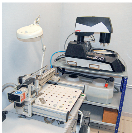
Оборудование для изготовления микрошлифов: координатно-фрезерный станок (на переднем плане) и шлифовальная машина
