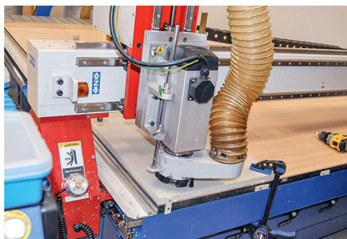
Раскрой полипропиленового листа на станке с ЧПУ
