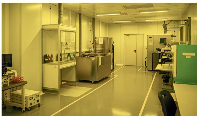
Участок фотолитографии. На заднем плане справа – лазерный сканер прямого формирования рисунка
