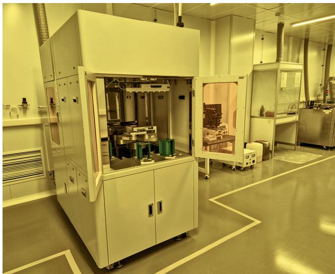
Оборудование для совмещения и экспонирования полупроводниковых пластин
