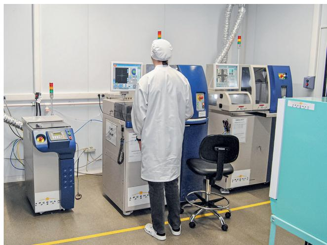
Оборудование дискового разделения пластин
