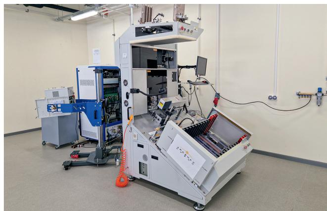
Стенд для измерения статических, динамических, вольт-фарадных, энергетических и тепловых параметров мощных приборов до 3 кВ, 400 А
