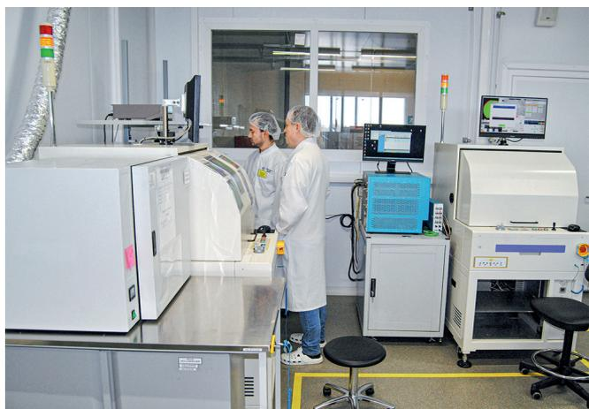
Зондовые станции контроля электрических параметров кристаллов на пластине
