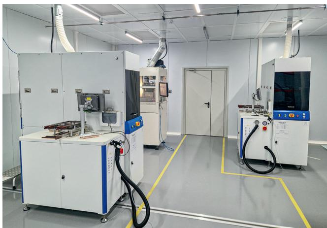
Оборудование для герметизации изделий в металлополимерных корпусах
