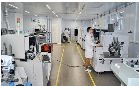
Автоматическое оборудование монтажа кристаллов в пластиковые корпуса и проволочной разварки
