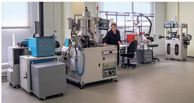
**Автоматическая установка контроля и маркировки компонентов (в центре) и установка упаковки в блистерную ленту (справа)**
